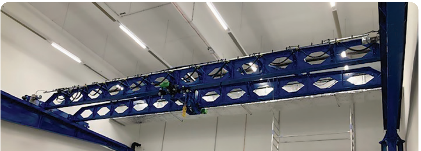
A nem párhuzamos övű, cellás tartószerkezet felhasználásával készült kétfőtartós daruszerkezet
