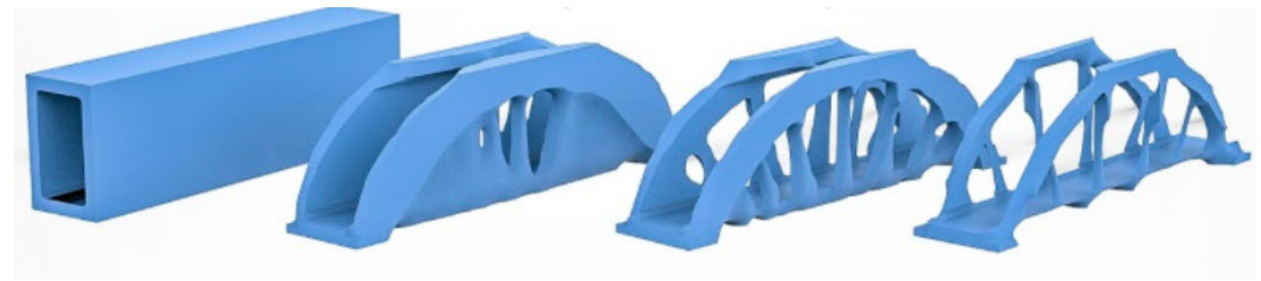
Topológiai optimalizálás eredményeként kapott, minimális tömegű tartókialakítás
